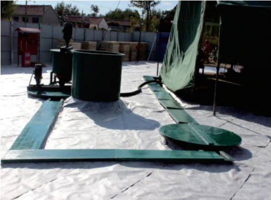
图 4 玻璃钢材质钻井液循环系统
