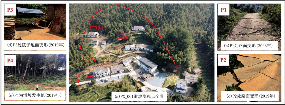
图 4 PX_001 滑坡隐患点形变迹象
